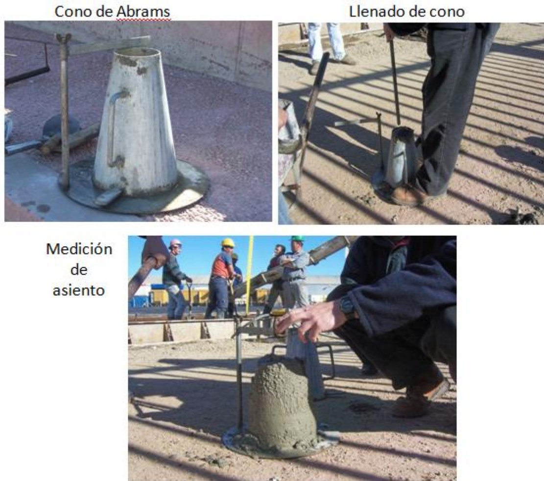
Figura 9. Realización del cono de Abrams in-situ
